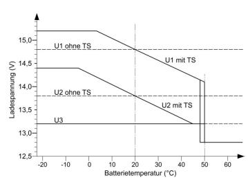
**ACHTUNG:** Unbedingt Batterie-Datenblatt bezüglich der hohen U1-Ladespannung **14,8 V** prüfen. Ungeeignete Batterien können durch Elektrolyt-Verlust vorzeitig altern! Einige Hersteller von AGM-/Vlies-Batterien schreiben zur Ladung auch 14.4 V-Ladeprogramme vor
