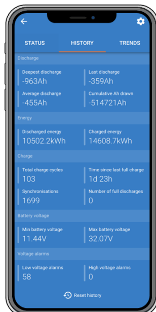
Verlaufsanzeige des Batteriemonitors in der VictronConnect App.
