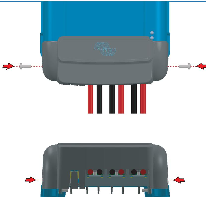
Schritt 3: Bringen Sie die Abdeckung der WireBox an und befestigen Sie sie mit zwei Schrauben.
