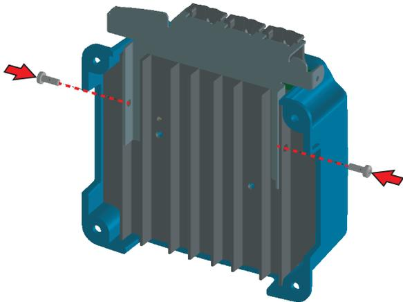
Schritt 1: Montieren Sie den "Stahlsocket" am MPPT, bevor Sie ihn an der Wand abringen
