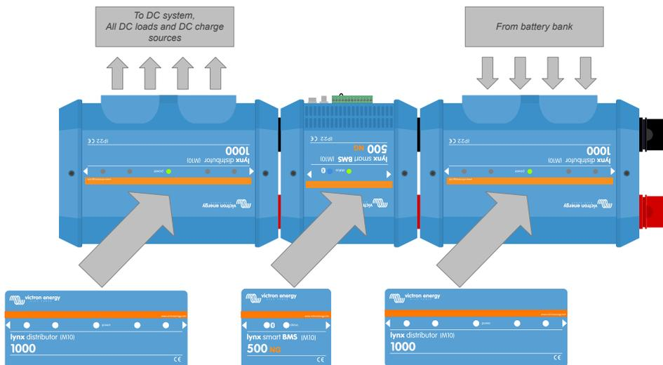
Beispiel für kopfüber montierte Lynx-Module: Die Batterien werden nun auf der rechten Seite angeschlossen, alle Lasten und Ladegeräte werden auf der linken Seite angeschlossen und die mitgelieferten Aufkleber werden angebracht.
