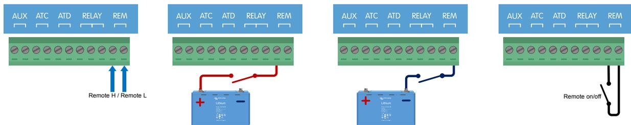
Einfacher ferngesteuerter Ein-/Ausschalter, der zwischen Pin 10 und Pin 11 oder Batterie Plus (oder Minus) und Pin 10 (oder Pin 11) verkabelt ist. Pin 12 und 13 sind nicht abgebildet.
