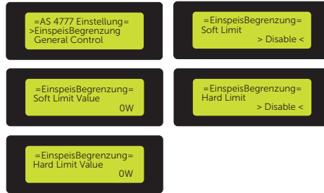
Abbildung 9-70 EinspeisBegrenzung in der Schnittstelle AS4777 Einstellung einstellen
