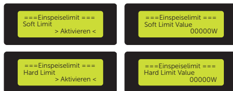
Abbildung 9-46 Soft Limit und Hard Limit in EinspeisBegrenzung einstellen
