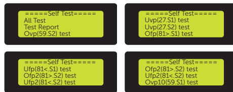
Abbildung 9-48 Zu erledigende Tests einstellen
