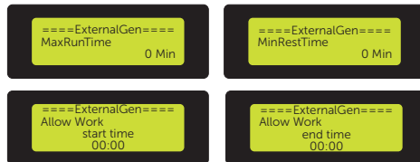
Abbildung 9-79 MaxRunTime, MinRestTime, Allow Working Period einstellen
