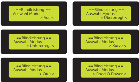
Abbildung 9-52 Einen Modus in Blindleistung auswählen
