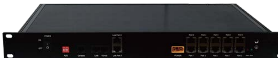
Jeder Kommunikationshub verbindet maximal 7 Batteriegruppen
