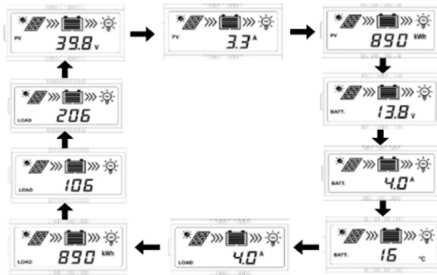
**Anmerkung:** Wenn keine Bedienung des Reglers stattfindet, wechseln die Anzeigen automatisch durch. Hierbei werden folgenden Anzeigen ausgelassen:
