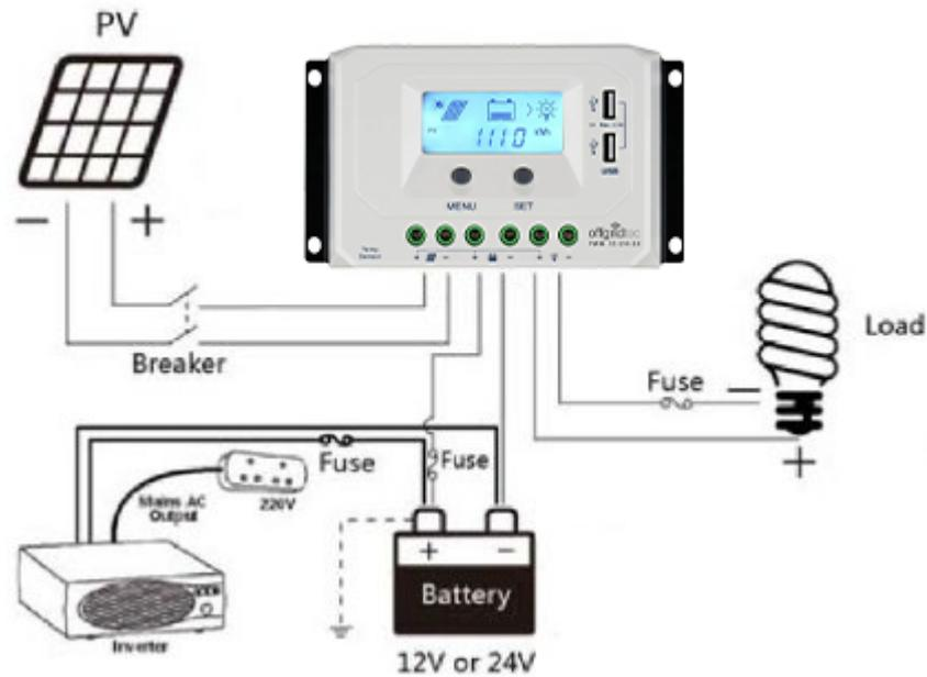
1. Schließen Sie die Komponenten an den Laderegler, wie im Bild oben dargestellt an und achten auf “+” und “-”. Schließen Sie immer zuerst die Batterie an, damit der Regler die Systemspannung erkennt. Während der Installation, bitte die Sicherung und den Schutzscharter deaktivieren. Sobald Sie den Regler erneut starten, werden die Einstellungen gespeichert.
