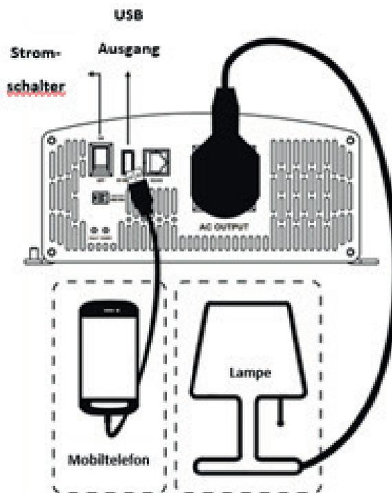
Schritt 1: Den Netzschalter des Wechselrichters auf OFF stellen
